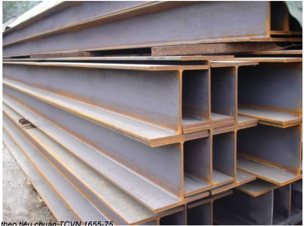
Bảng quy cách, trọng lượng thép hình H theo tiêu chuẩn-TCVN 1655-75 Specifications of H-beam according standard TCVN 1655-75
